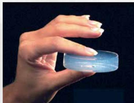
**Dall'unione dell'Aerogel con speciali fibre rinforzate nasce Spaceloft®**
